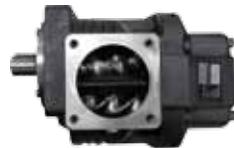
Высокоэффективный винтовой блок нового поколения ENDURO (Финляндия) или ROTORCOMP (Германия), сконструированный с использованием программ вычислительной гидродинамики и методов конечных элементов. Новый профиль ротора с оптимальной комбинацией лопастей обеспечивает минимальные потери при сжатии, снижает требуемый крутящий момент и потребление энергии, увеличивая энергоэффективность процесса;
